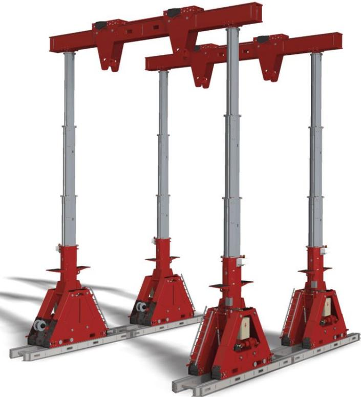
Il sistema Gantry cranes è un telaio di sollevamento idraulico mobile, semovente, ad altezza variabile. I carroporti sono progettati per funzionare su superfici lisce (piastre in acciaio o binari). Un meccanismo di spostamento laterale permette di traslare il carico dando al sistema la capacità di muovere il carico nelle 3 direzioni.
