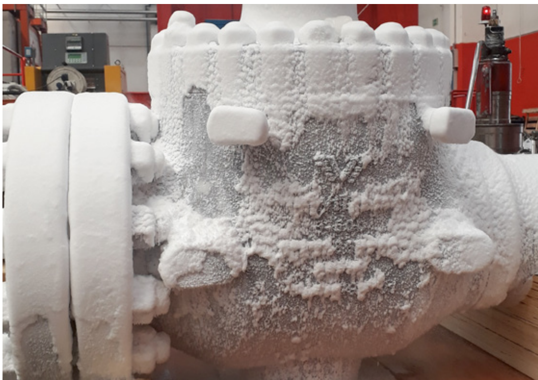
Valvitalia Valvola sotto test criogenico
