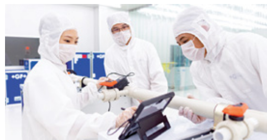
Ispezione di un cordolo di saldatura eseguito con IR-63 M. Fonte:
