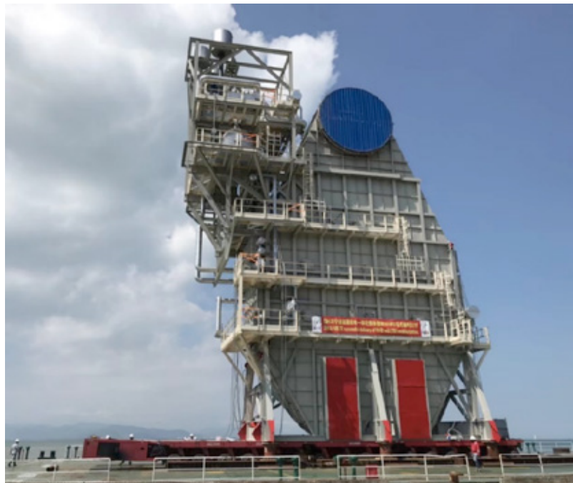
Figure 8 - Vertical HRSG (Courtesy of Boustead International Heaters - BIH)
