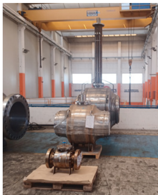
Valvitalia - Valvole testate per trasporto idrogeno al 100%
