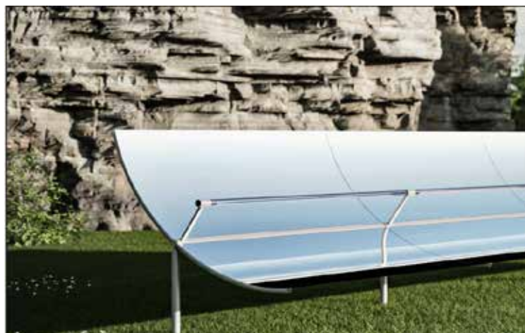
Figura 6 – Concept del modulo di generazione H 2 Giallo: PEC e concentratore PTC
