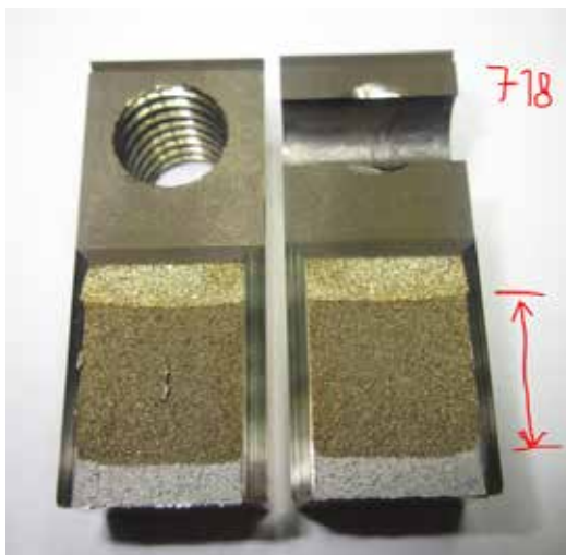
Figura 2 - Risultato test KIH su provino Inconel 718
