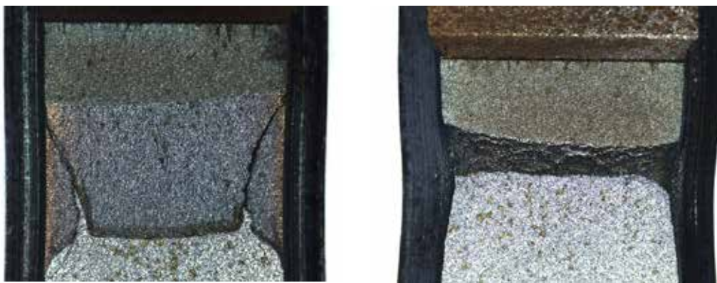
Figura 3 - Prova JR su LF2: provino testato in idrogeno a 260 bar (sx) VS provino testato in aria (dx)
