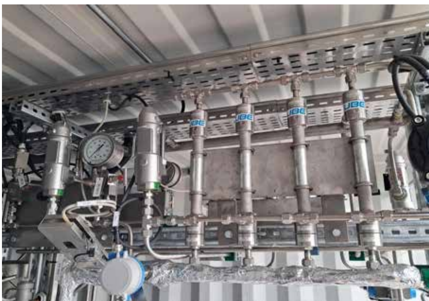
Impianto Pilota progetto "HYMAGE" - Moduli a membrana per la separazione e purificazione dell'e-methane
