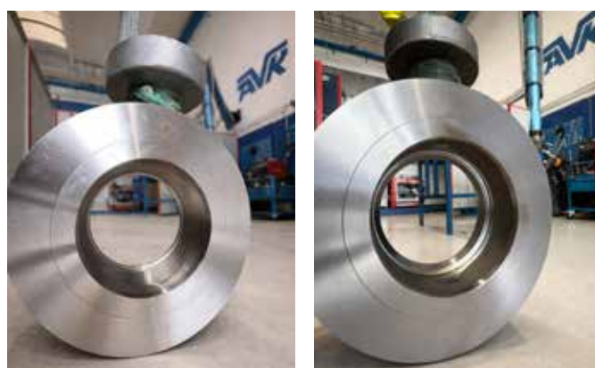
Figura 1 - Profilo interno valvola ottimizzato (sx) VS profilo interno valvola standard (dx), in fase intermedia di lavorazione
