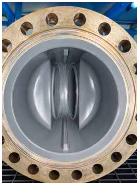
Valvola con rivestimento interno “FBE” completato
