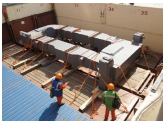
Fig. 7 - Tre container platform con caricato e rizzato un collo da 111 t con peso distribuito tramite assi in legno
