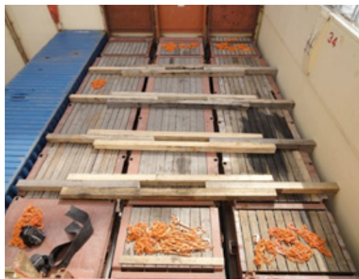
Fig. 5 - Fardaggio in legno e catene pronte per il rizzaggio dei colli a bordo
