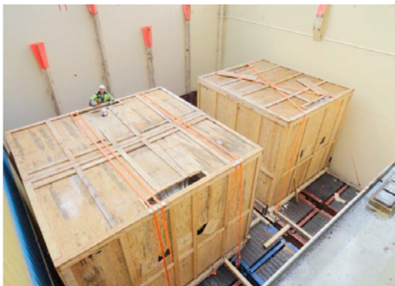
Fig. 1 - Esempio di carico di due casse di circa 40 t ciascuna a bordo di una nave portacontainer dopo aver disposto 5 container platform che fungono da fondo stiva per lo stivaggio e il rizzaggio delle casse a bordo
