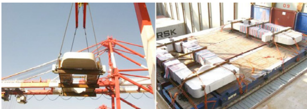
Fig. 4 - Due colli da 41 t ciascuno sistemati su un letto di flat
