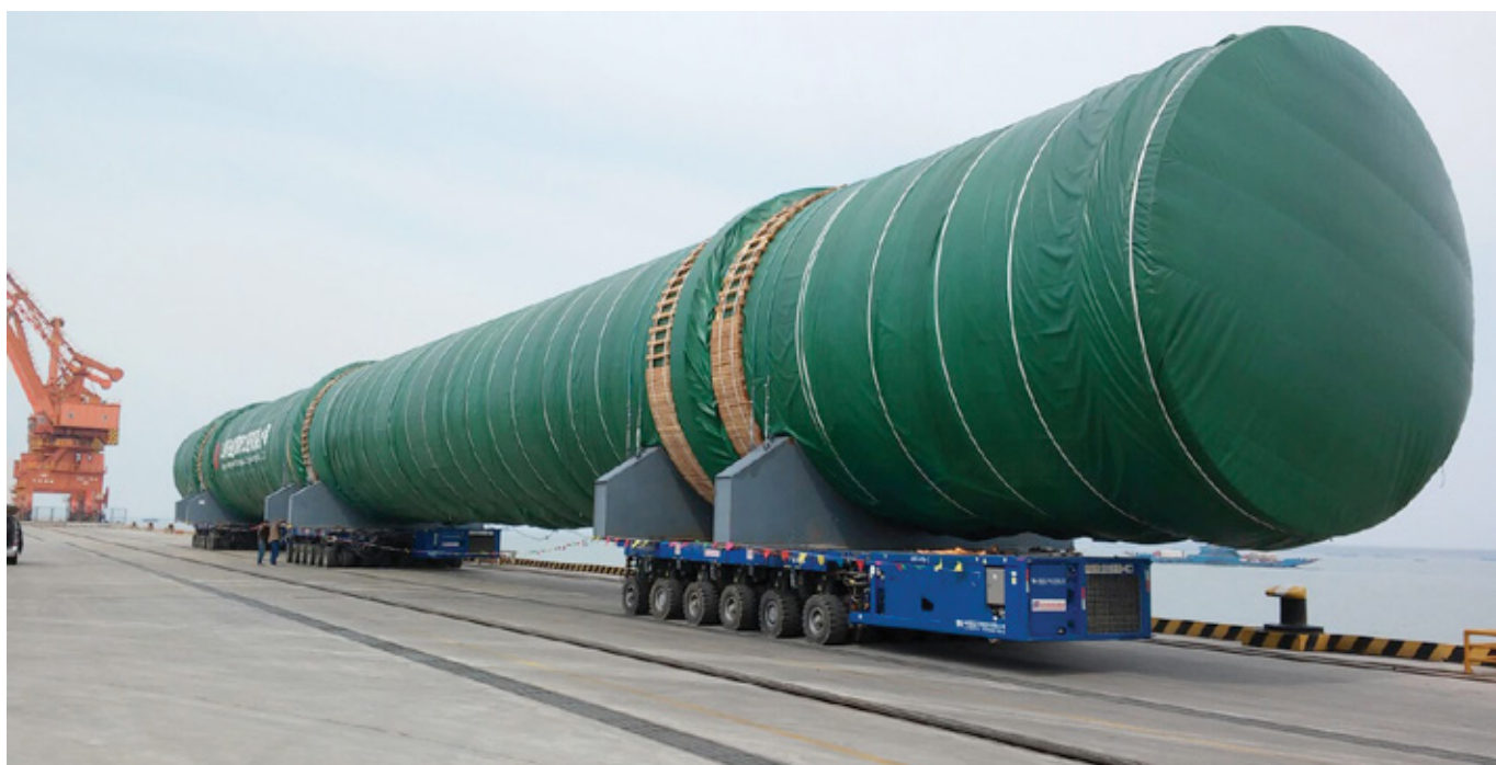
A seguire una serie di foto dell'SSP Reactor x 2 – each cm 8500 x 700 x 705 lwh – 550000 kg from Gangxin to Corpus Christi on Mv Jumbo Jubilee
