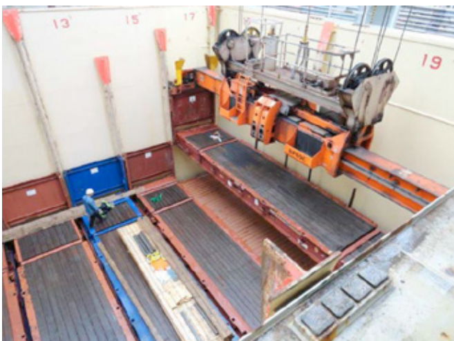
Fig. 3 - Preparazione del letto di flat, come è comunemente chiamato il posizionamento fianco a fianco di container platform per creare il fondo stiva pronto a ricevere i colli da caricare
