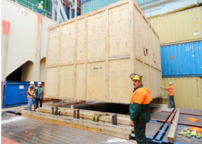
Fig. 2 - Operazioni di posizionamento di una cassa da 40 t sul cosiddetto letto di flat con fardaggio in legno
