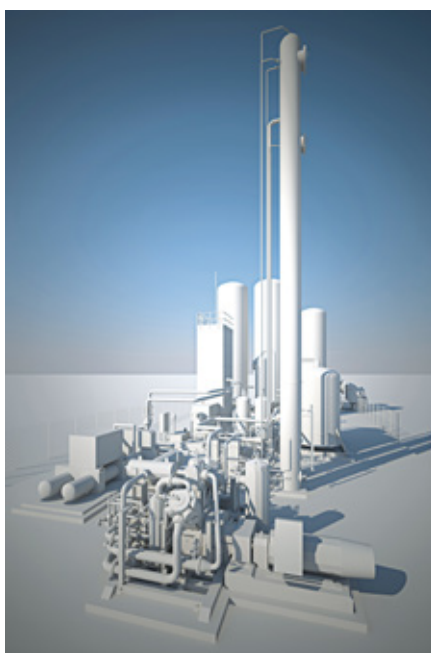
Impianto di upgrading e liquefazione LNG a riciclo di azoto
